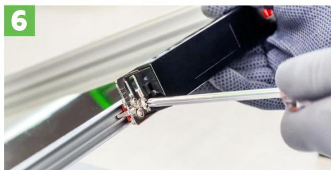
Вкрутите саморез в фиксатор с доводчиком
